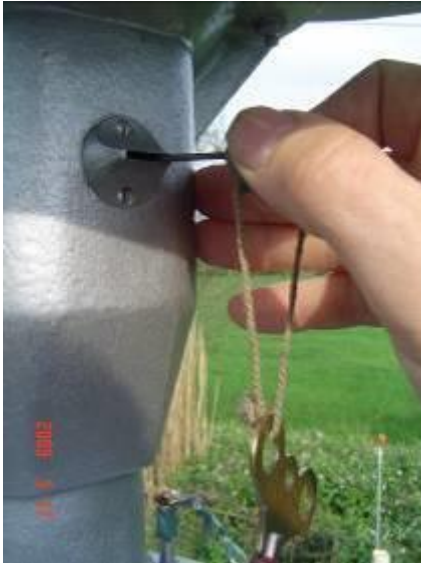
Bild 3. Anritzen der Fangfolie; hier mit einem knapp ca. 1,8 mm dicken Nagel durch den Ansaugschlitz hindurch;
