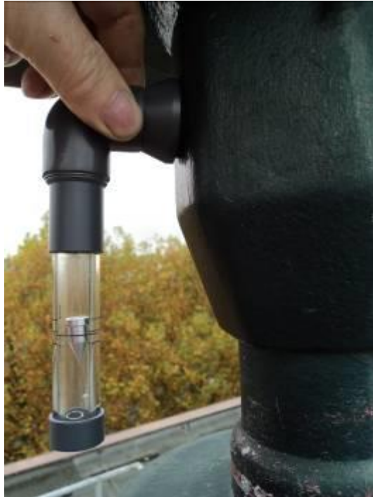
Bild 2. Rotameter im Einsatz: Oberkante des Schwebekörpers hier bei 11 l/min.
